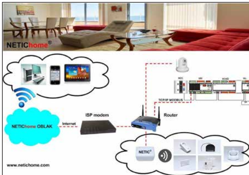
Slika 6. Oddaljeno in lokalno upravljanje preko spletnega brskalnika na osebnem računalniku, iOS-napravah (iPhone, iPad) in napravah Android v sistemu e-storitvev Netichome [vir: dokumentacija podjetja Goap, d. o. o.]
