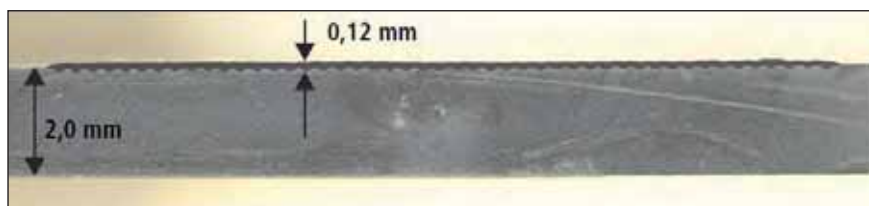
Slika 1. Makroobrus navara, izdelanega z laserskim žarkom in z žico premera 0,5 mm; s stopnjo prekrivanja predhodnega varka 20 % [1].
