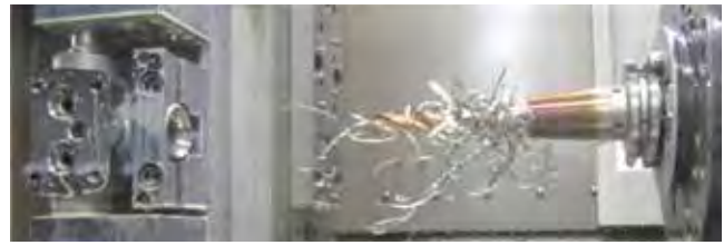
Slika 10 : Prikaz faze strojne obdelave tiskanega kovinskega ohišja
