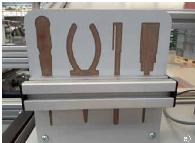
Slika 4 : Tabla za orodje brez orodja (a); z orodjem (b).
