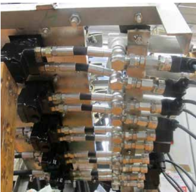
Slika 5 : Merilna mesta in delovni izhodi zavornih ventilov
