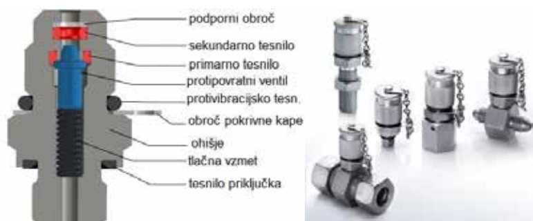
Slika 4 : Zgradba merilnega priključka in njegov videz (levo - Hydrotechnik, desno - Stauff)
