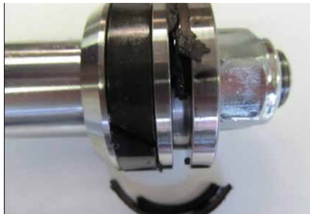
Slika 7 : Primer prekomerno poškodovanega batnega tesnila hidravličnega valja
