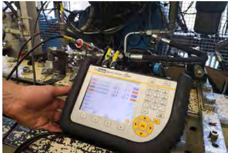
Diagnostična enota za merjenje hidravličnih veličin
