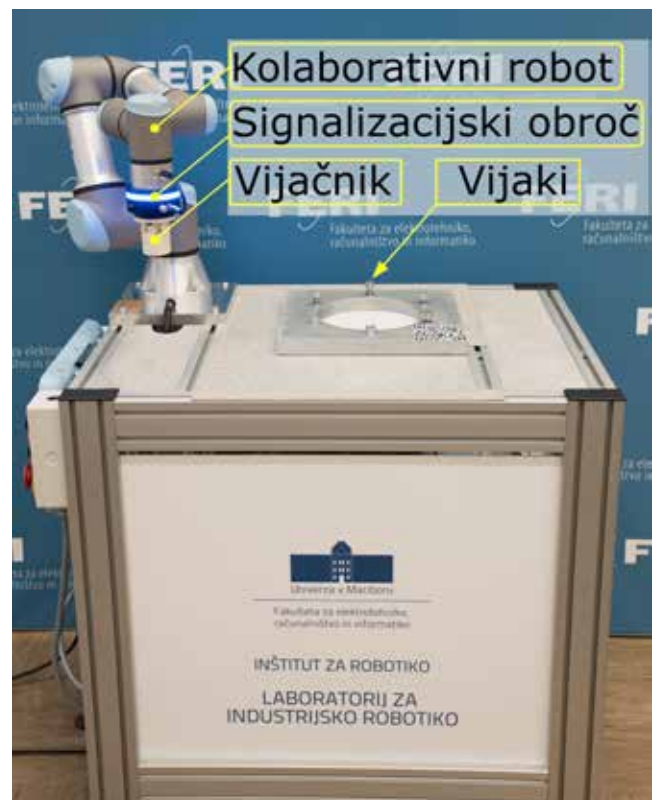
Slika 1 : Laboratorijska postavitve hibridne delovne celice
