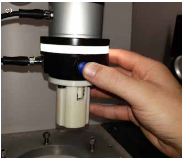
Slika 4 : Detekcija dotika s preklopom v kinestetično vodenje: a) človek se dotakne robota b), kinestetično vodenje - človek lahko robota prosto premika v določenem območju delovnega prostora, c) človek lahko sproži nadaljnje izvajanje robotskega programa.
