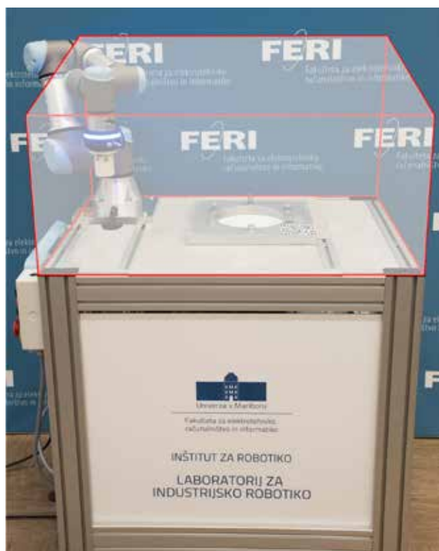
Slika 7 : Varnostna omejitev delovnega prostora – rdeče obrobljen in svetlo poudarjen kvader predstavlja prostor, v katerem je lahko orodje robota.
